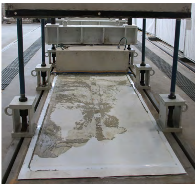
Bild 9 Verpresskörper aus Mikrofeinzement-Suspension, Abschnitt 9,0 bis 12,0 m (Feldlänge: 12 m, Nominelle Spaltweite: 0 mm, Verpresseinrichtung: Schlauch \varnothing_i 10 mm)
