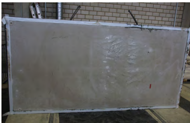
Bild 6 Verpresskörper aus Geopolymer (Nominelle Spaltweite: 3 mm, Verpresseinrichtung: Stutzen \varnothing_i 24 mm)
