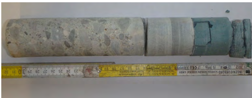
Bild 10 Bohrkern an der Fehlstelle; von links (innen) nach rechts (außen): ursprünglicher Innenschalenbeton mit Körnung, bauzeitliche Verfüllung mit Zementleim, neu eingebrachte blaugraue Zementsuspension
