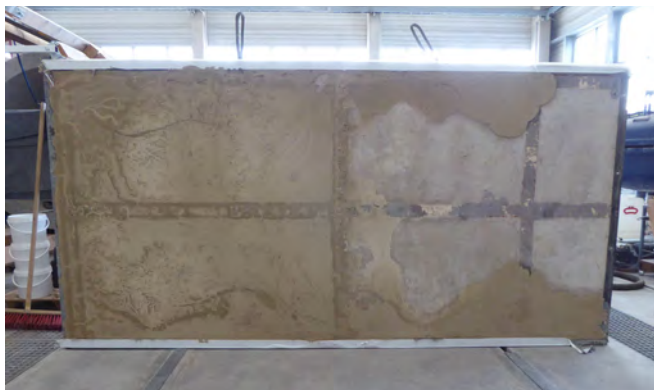
Bild 8 Verpresskörper aus Zementsuspension (Füllbinder), Abschnitt 3,0 bis 6,0 m (Feldlänge: 12 m, Nominelle Spaltweite: 0 mm, Verpresseinrichtung: Stützen \varnothing_i 24 mm)
