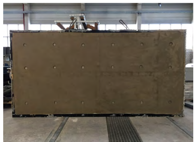
Bild 4 Versuchsfeld, Unteransicht Im Raster gelochter Verpresskörper für Schichtdickenmessungen
