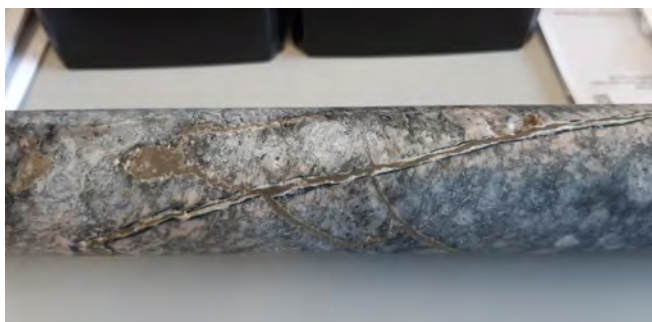
Bild 8 Bohrkern aus der Tertiärphase zum Nachweis des Injektionserfolgs
