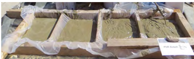
Bild 5 Hybridmaterial mit 10 %, 20 %, 30 % und 40 % PU-Zugabe
